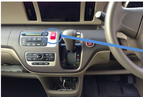
シフト+エアコンパネルカバー裏のハザードスイッチカプラ
